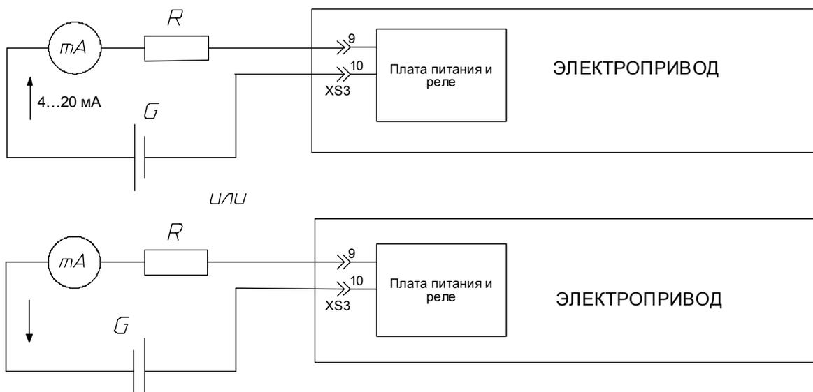
G – источник внешнего питания токового датчика,
