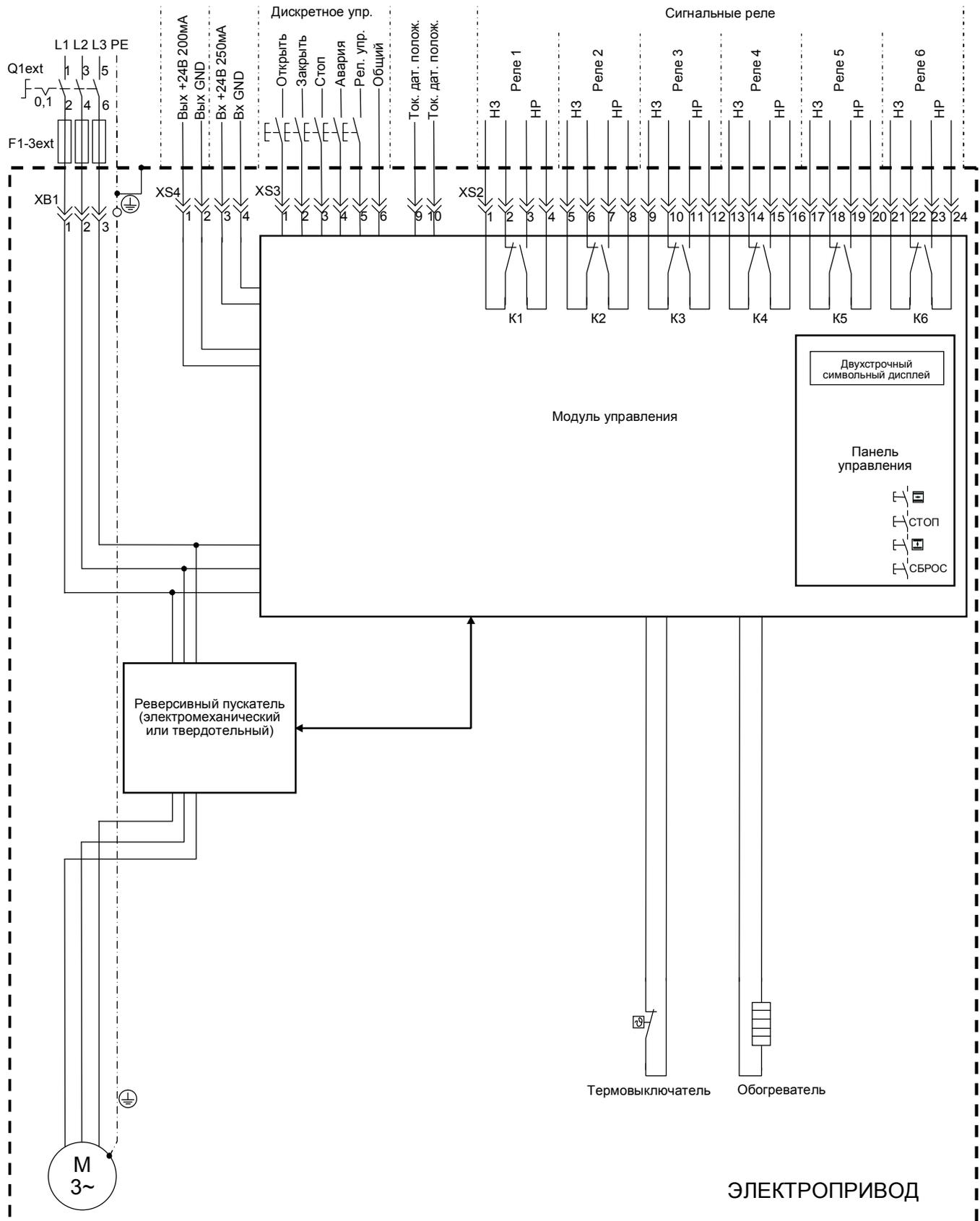
Назначение входов дискретного управления определяется настройками в меню привода.
