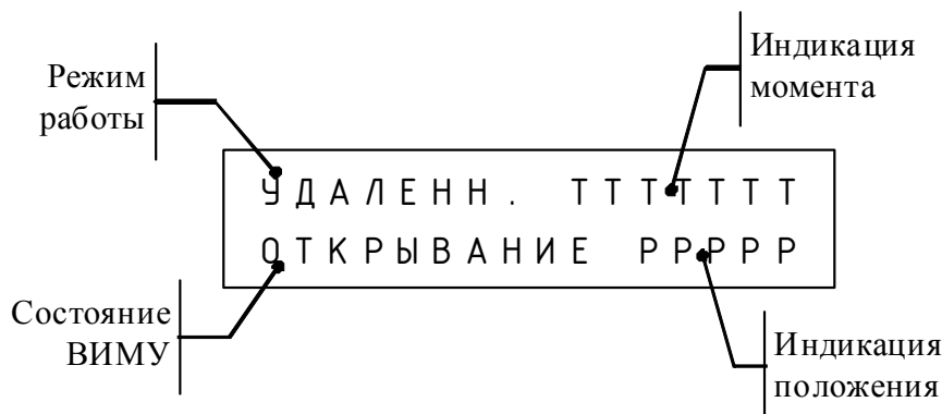
Рисунок 10 – Структура отображения информации на дисплее
