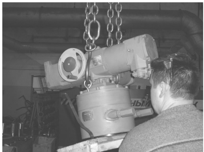
Рисунок 9 – Схема строповки редуктора с приводом
