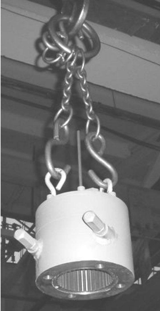
Рисунок 8 – Схема строповки редуктора
