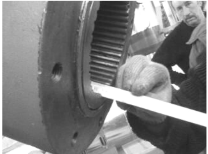
Рисунок 7 – Проверка присоединительных размеров
