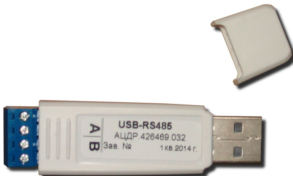
Рисунок Ж.3 – Преобразователь интерфейсов USB в RS-485 BOLID
